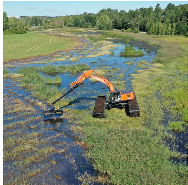
Kelluvan kaivinkoneen pitkään puumiin liitetty niittoterä mahdollistaa upottavien ruovikkoreunusten raivauksen. Kuva: Salla Waldmann.
